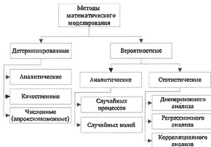
Рисунок 1 – Классификация методов математического моделирования
