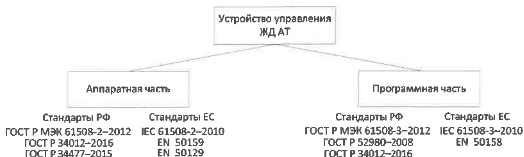
Рисунок 1 – Требования к аппаратной и программной части устройств
