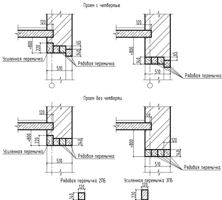
Рисунок 15 – Устройство проемов с использованием брусковых перемычек ПБ
