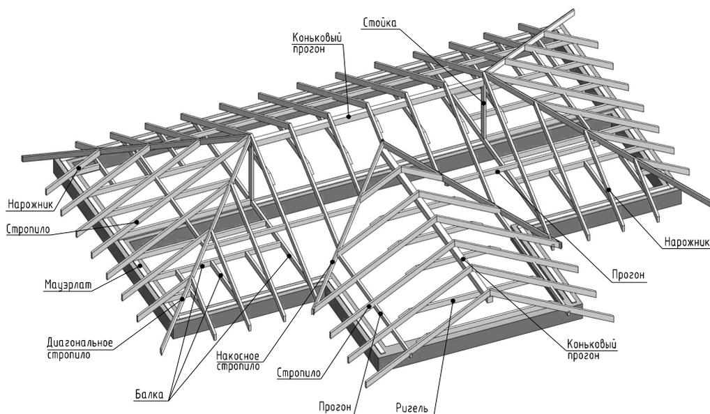
Рисунок 20 – Примеры стропильных систем:
