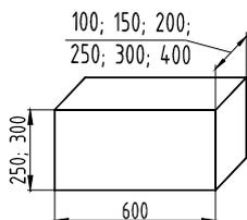
Рисунок 8 – Наиболее распространенные размеры ячеистого блока
