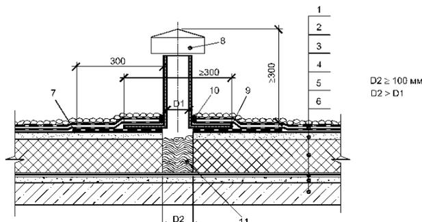
Рисунок 37 – Установка аэратора на неэксплуатируемой кровле при водоизоляционном ковре по стяжке:
