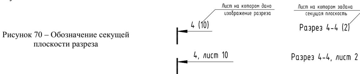
Рисунок 70 – Обозначение секущей плоскости разреза
