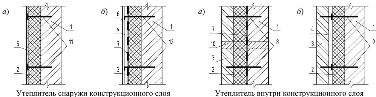
Рисунок 10 – Основные конструкционные решения утепленных наружных стен:
