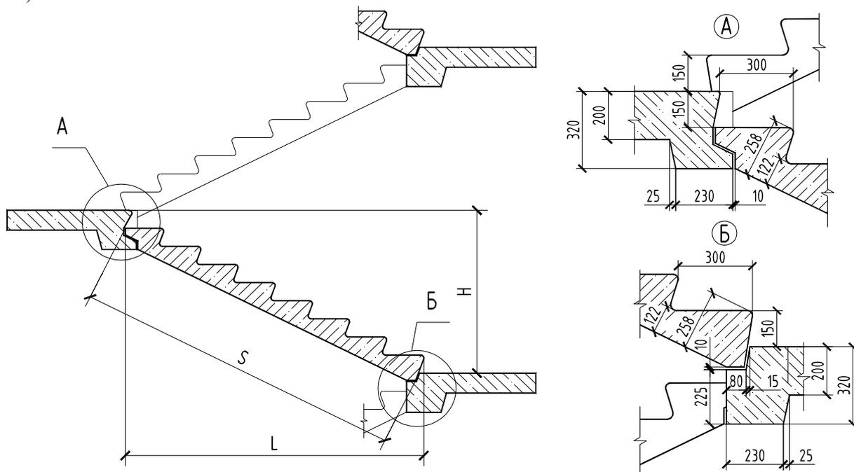
Рисунок 42 – Сборные (плоские) железобетонные лестницы, применяемые в зданиях с поперечными несущими стенами. Лестничный марш ЛМ (плоский без фризových ступеней), площадка 1 ЛП:
