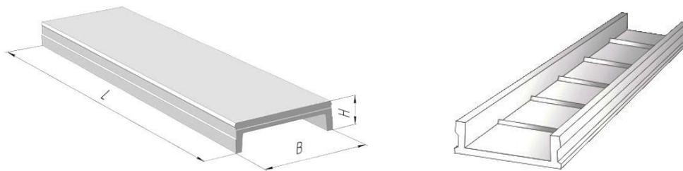
Рисунок 2 – Ребристые плиты
