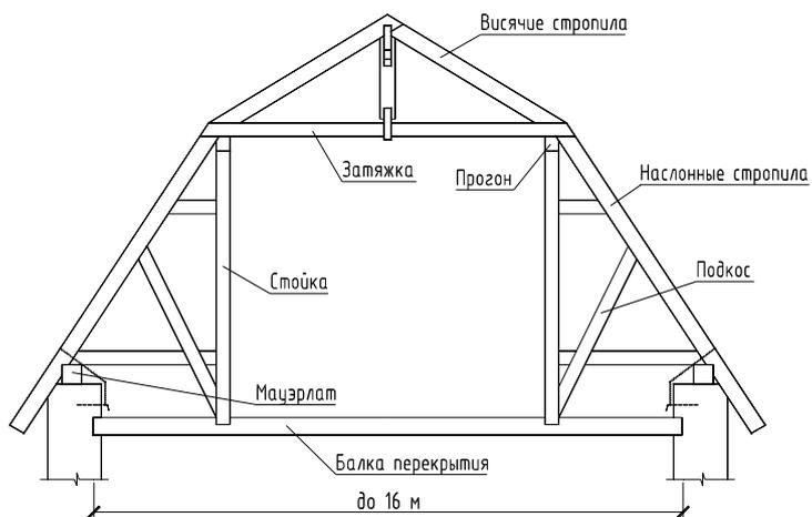
Рисунок 19 – Элементы стропильных систем
