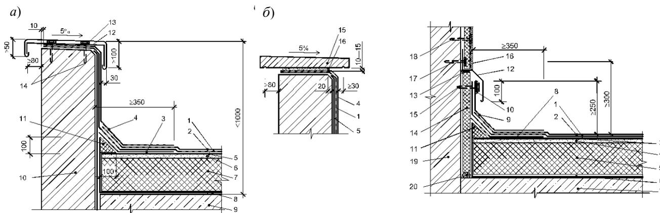
Рисунок 32 – Примыкание двухслойной кровли с выводом на парапет *a* – под металлический лист; *б* – под парапетную плиту;
