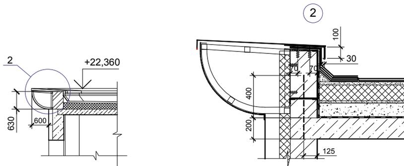
Рисунок 71 – Обозначение выносного элемента
