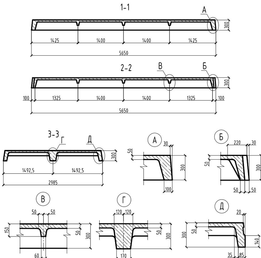
Рисунок 3 (окончание) – Форма ребристых плит высотой 300 мм (ГОСТ 21506–2013)
