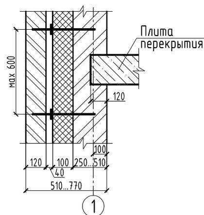
Рисунок 11 – Основные конструктивные размеры каменной стены трехслойной конструкции
