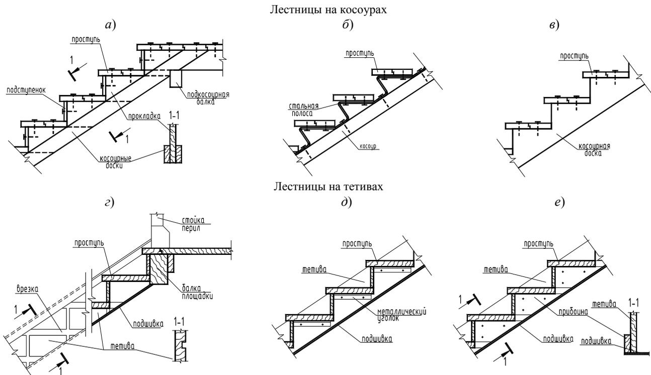
Рисунок 41 – Варианты конструктивного исполнения деревянной лестницы:
