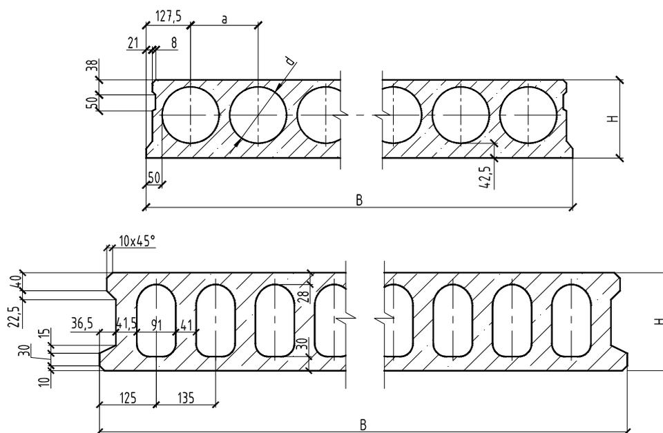
Рисунок 5 – Форма многопустотных плит (ГОСТ 9561–16) с круглыми пустотами (ПК) и с грушевидными пустотами (ПГ)
