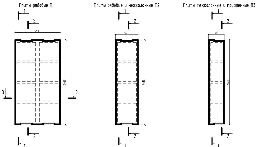
Рисунок 3 (начало) – Форма ребристых плит высотой 300 мм (ГОСТ 21506–2013)
