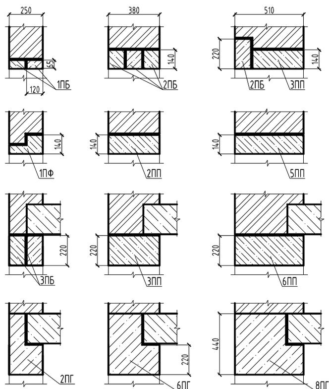
Рисунок 16 – Возможные схемы установки железобетонных перемычек
