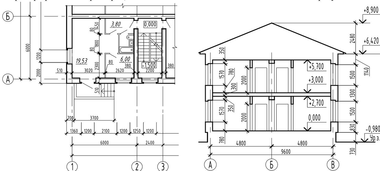
Рисунок 66 – Пример нанесения размеров на плане и разрезе здания
