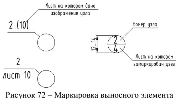
Если графическое изображение выбранного элемента размещено на другом листе комплекта рабочих чертежей, то маркировка и обозначение узла выполняются в соответствии с рисунком 72.
