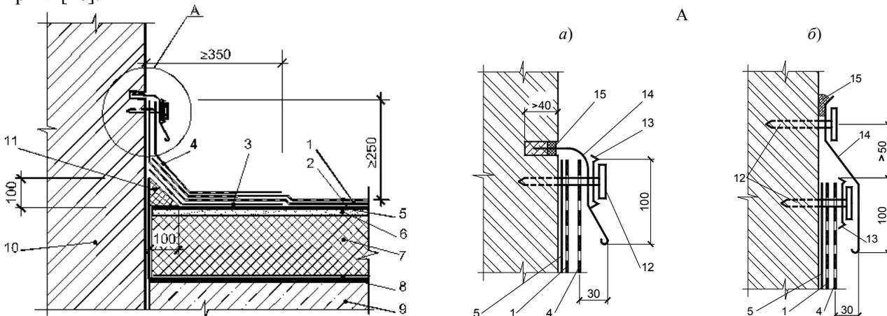
Рисунок 31 – Примыкание двухслойной кровли к стене при сплошной наклейке водоизоляционного ковра:
