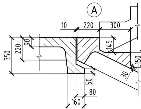
Рисунок 45 – Сборные ребристые железобетонные лестницы, применяемые в зданиях с поперечными
