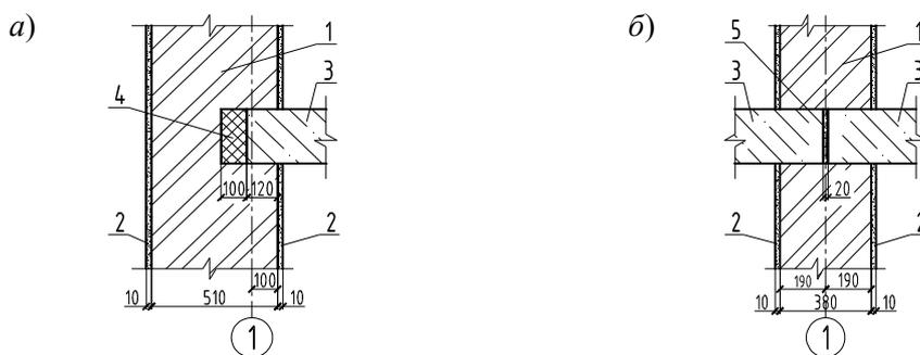
Рисунок 9 – Однослойная каменная стена без утепления:
