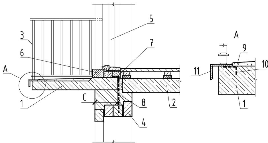
Рисунок 55 – Устройство балкона:
