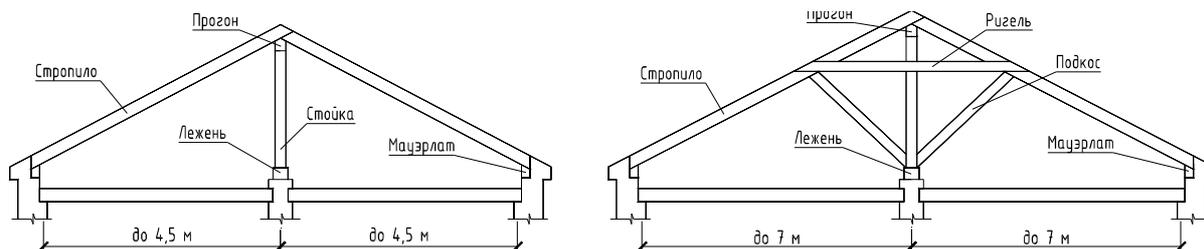
Элементы комбинированной системы с наслонными и висячими стропилами
