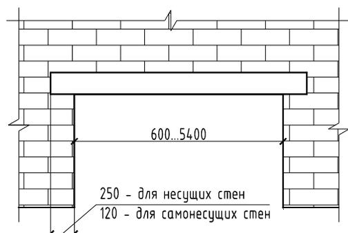
Рисунок 14 – Определение длины перемычки
