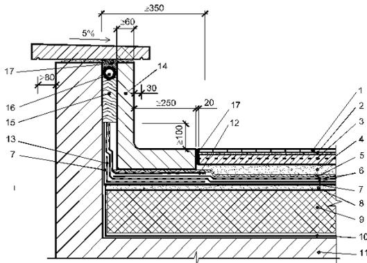
Рисунок 34 – Примыкание эксплуатируемой под пешеходные нагрузки кровли со сборной железобетонной защитной стенкой:
