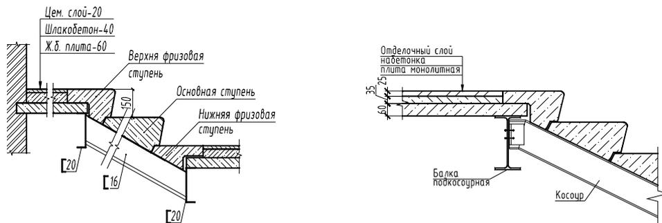
Рисунок 51 – Варианты устройства лестницы из железобетонных ступеней:
