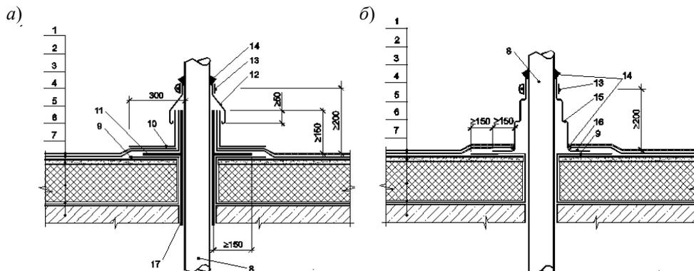
Рисунок 36 – Варианты пропуска труб через кровлю:
