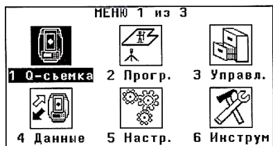
Рисунок 4.4 – Главное меню тахеометра
