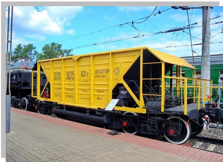
Рисунок 4.11 – Хоппер-дозатор
