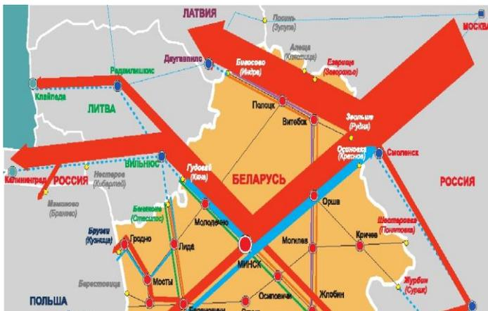
Рисунок 1.5 – Схема направлений транзитных грузопотоков по Белорусской железной дороге
