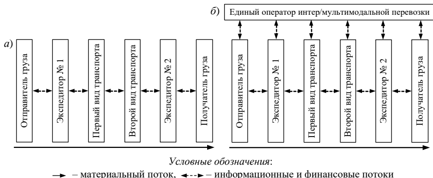
Рисунок 2.2 – Традиционная (а) и логистическая (б) организация перевозки с участием нескольких видов транспорта
