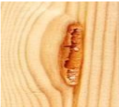
Рисунок 12 – Односторонний смоляной кармашек
