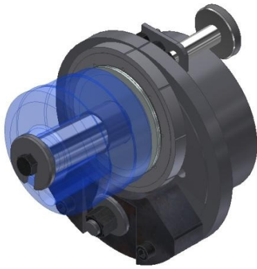
Рисунок 1 – Приспособление для обработки карманов ротора А1-112/25.10.000СБ аксиально-поршневого насоса
