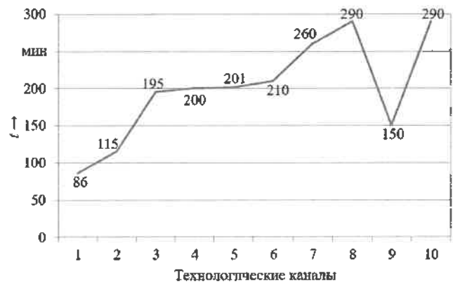
Рисунок 8 – Диаграмма зависимости времени обработки поездов от количества технологических каналов на СПВ
