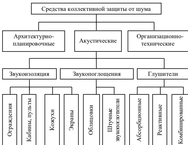
Рисунок 2 – Средства коллективной защиты от шума на пути его распространения
