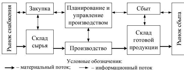
Условные обозначения: → – материальный поток; ⇄ – информационный поток Рисунок 5.3 – Принципиальная схема внутрипроизводственной (микрологистической) системы
