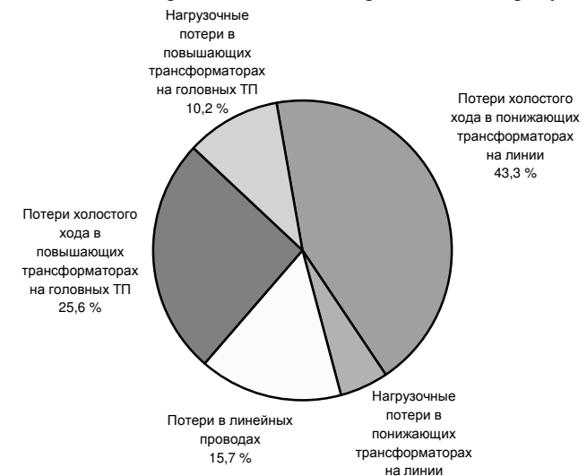
Рисунок 4.1 – Баланс потерь электрической энергии в линиях АБ
