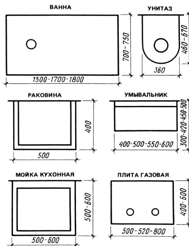
Рисунок 16 – Размеры санитарно-технического оборудования
