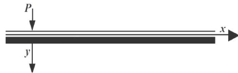
Рисунок 7 – Схема нагружения балки на упругом основании системой сосредоточенной силой
