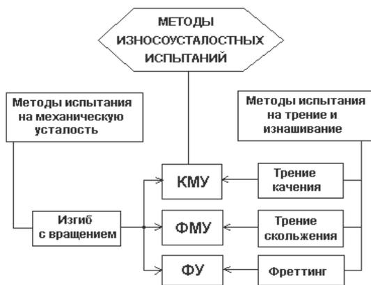
Рисунок 1 – Формирование методов износоусталостных испытаний при главном вращательном движении:
