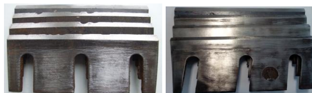
Рисунок 24 – Характер эксплуатационных повреждений стальных ножей MWS (слева) и чугунных ножей без лазерного упрочнения (справа)
