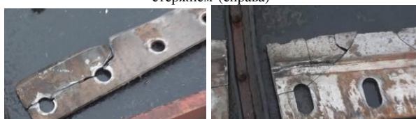
Разрушенные стальной (слева) и чугунный (справа) ножи Рисунок 13 – Краш-тесты чугунных и стальных ножей
