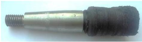
Рисунок 8 – Образец резины, достигший термодеструкции
