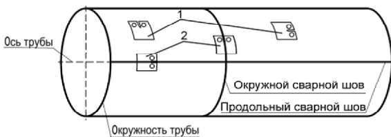
Рисунок 2 – Схема вырезки образцов из материала трубы для испытаний на трещиностойкость:
