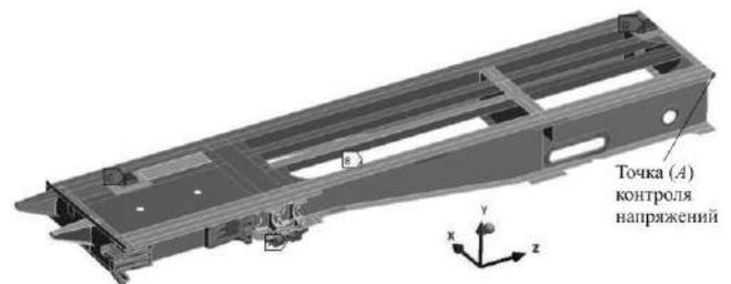
Рисунок 12 – Расчетная модель (1/4 вагона)
