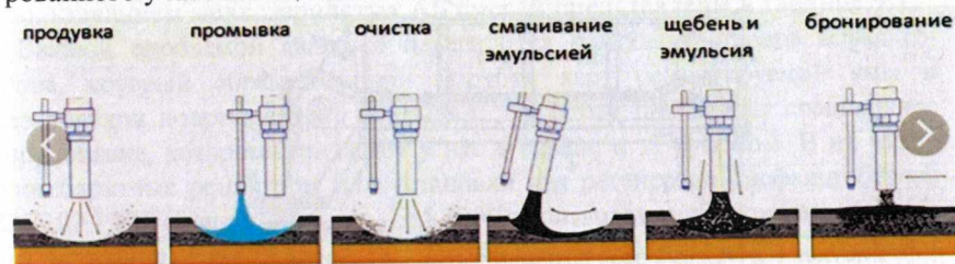
Рисунок 9.1 – Принципиальная схема ямочного ремонта эмульсионно-минеральной смесью
