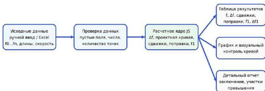
Рисунок 1 – Структура обработки исходных данных в программе
