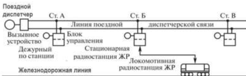
Для организации связи с локомотивными бригадами на маршруте движения используется комбинированный способ организации р. св. – линейная радиосеть: радиосеть, построенная по радиопроводному принципу и обеспечивающая непрерывную связь между стационарными и подвижными
