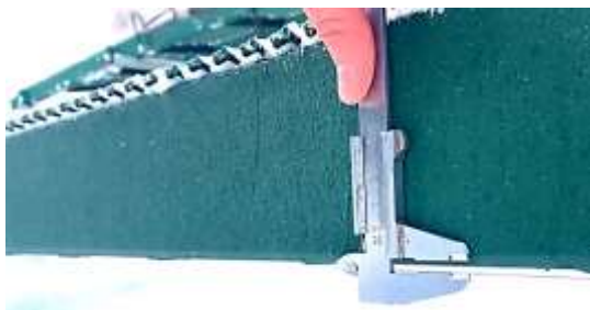
Рисунок 3 – Определение величины строительного подъема СРММП-2
