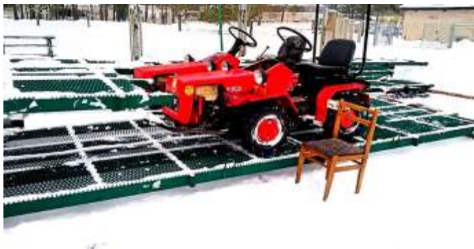
Рисунок 4 – Испытание СРММП-2 двумя мини-тракторами МТЗ-Беларус-132Н
