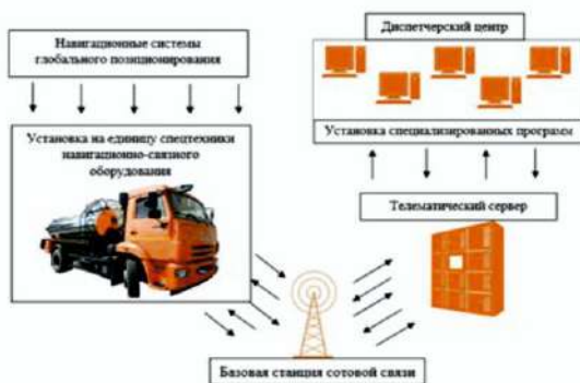
Рисунок 2 – Система автоматизированной работы дорожной техники
