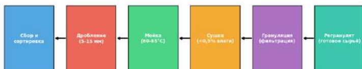
Рисунок 1 – Технологическая цепочка подготовки полимерной основы
