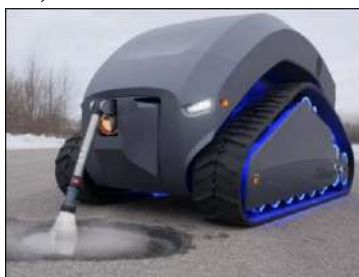
Рисунок 1 – Универсальная машина-робот для профилактики разрушений асфальтобетонного покрытия автомобильной дороги:
