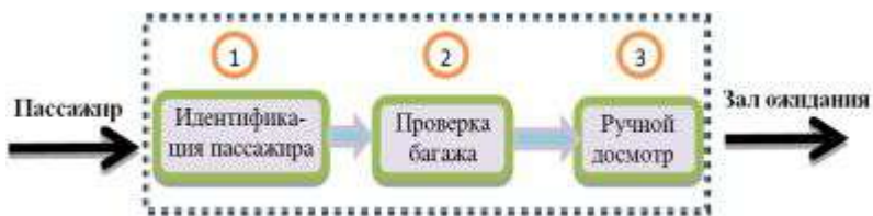
Рисунок 4 – Модель очереди процесса входа пассажиров в ТПУ
