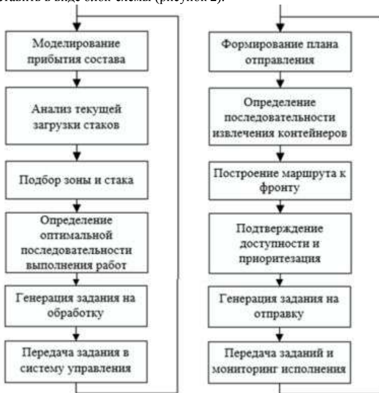
Рисунок 2 – Блок-схема алгоритма обработки контейнеров по прибытии и отправлении
