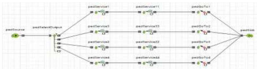
Рисунок 2 – Блок-схема логики моделирования входа пассажира на первом этаже Южного вокзала Гуанчжоу
