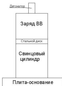
Рисунок 5.2 – Схема метода оценки бризантности ВВ по пробе Гесса
