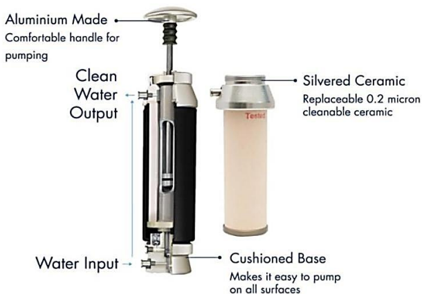
Рисунок 6 – Типовой индивидуальный фильтр с пористым керамическим фильтрующим картриджем
