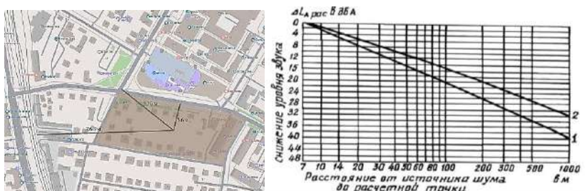
Рисунок 2 – Снижение уровня звука в зависимости от расстояния между источником шума и расчетной точкой
