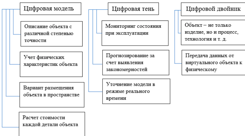
Рисунок 1 – Функции цифровой модели, цифровой тени и цифрового двойника
