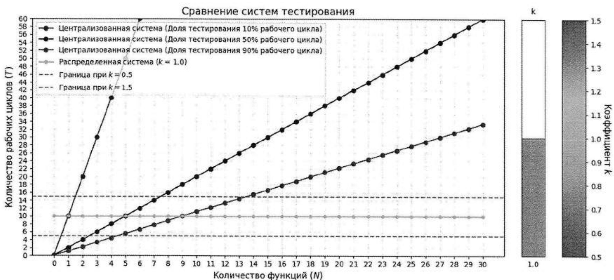
Рисунок 3 – Графический анализ зависимости длительности тестирования систем
