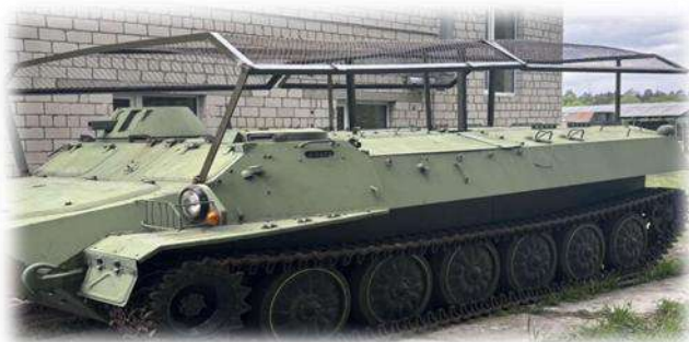
Рисунок 6 – МТЛБ, оборудованная противодронным козырьком
