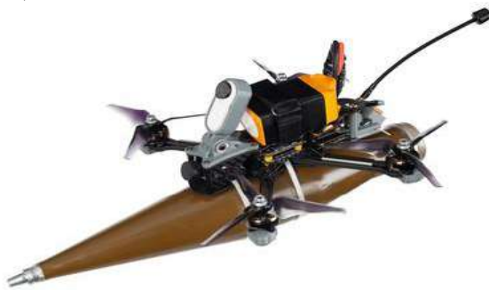
Рисунок 2 – Самодельное БПЛА с кумулятивной гранатой от РПГ-7
