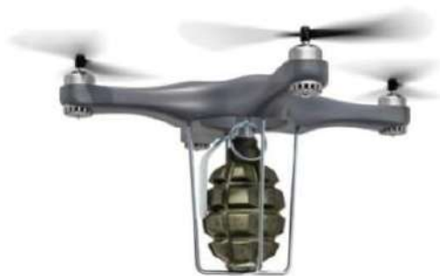
Рисунок 1 – БПЛА типа «Мэйвик» с ручной гранатой Ф-1
