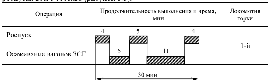
Рисунок 6.4 – Модель роспуска состава с вагонами ЗСГ ( \bar{O}_{\text{СНА}} = 2 ; q_{\text{СНА}} = 3 )
