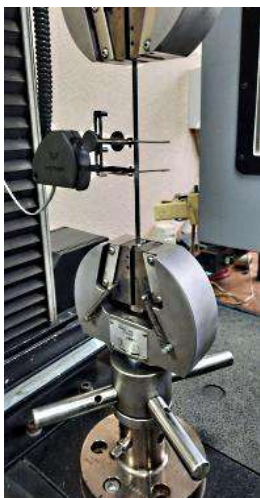
Рисунок 1 – Универсальная машина Инстрон 5567 и навесной контактный экстензометр
