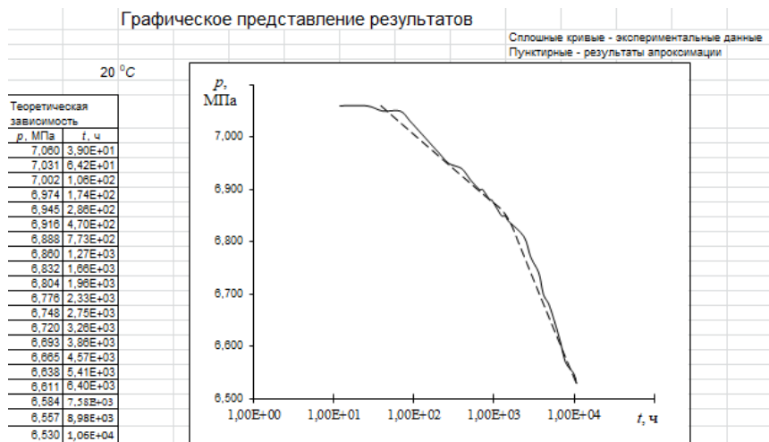
Рисунок 3 – Сравнение экспериментальных и расчетных зависимостей для температуры испытаний 20 °С
