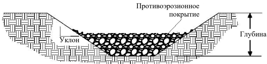
Рисунок 2.13 – Типовой профиль растительного канала
