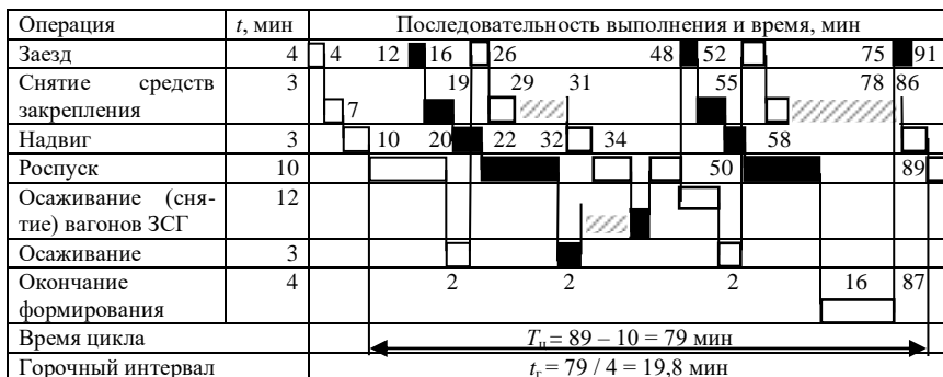
Рисунок 4.4 – Горочный технологический график работы механизированной двухпутной горки при двух горочных локомотивах и \beta_{зст}=0,25
