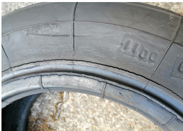
Рисунок 2 – Крупная трещина в поверхностном слое резины
