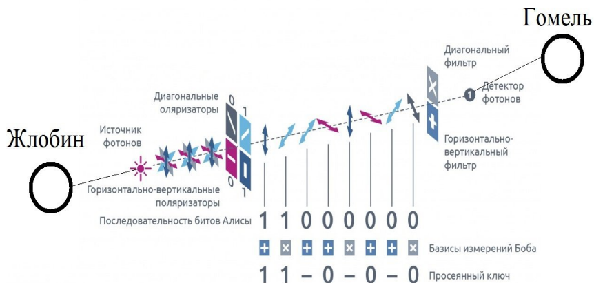
Рисунок 3 – Квантовый канал связи между станциями Жлобин и Гомель
