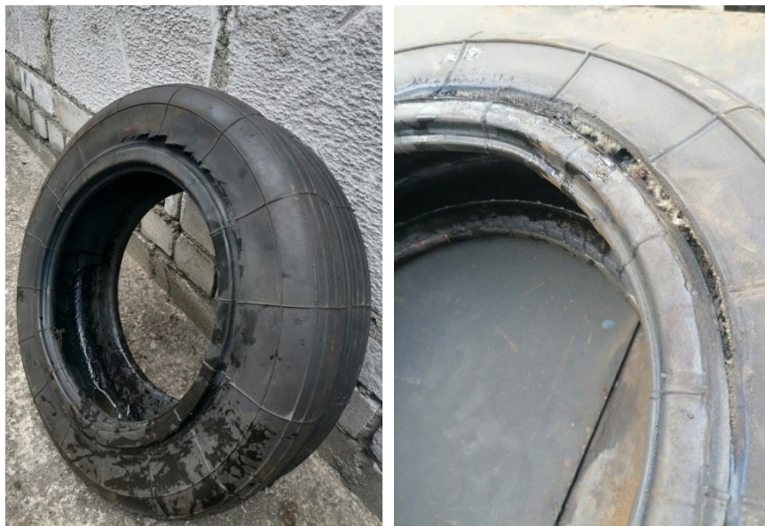
Рисунок 3 (начало) – Разрыв резинокордного слоя вместе с капроновым кордом
