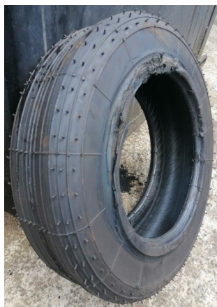
Рисунок 4 – Износ поверхностного слоя резины под фланцами крепления
