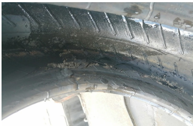
Рисунок 3 (окончание) – Разрыв резинокордного слоя вместе с капроновым кордом – износ поверхностного слоя резины до стального корда под фланцами крепления РКМ (рисунок 4).
