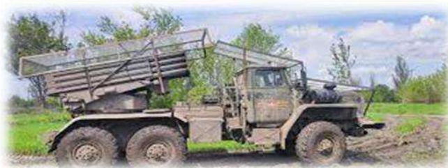
Рисунок 3 – БМ-21 «Град» на базе автомобиля Урал-375 оборудованный противодронным козырьком
