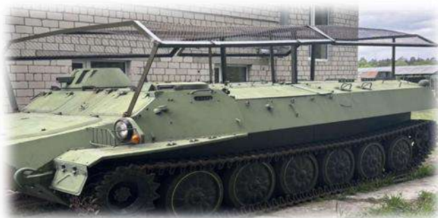
Рисунок 6 – МТЛБ, оборудованная противодронным козырьком
