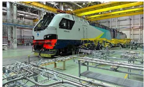
Рисунок 7 – Стенд диагностики электровоза при приёмке его в эксплуатацию
