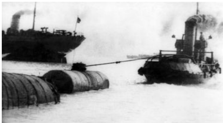
Рисунок 3 – Крепление цистерн к буксирному тросу
