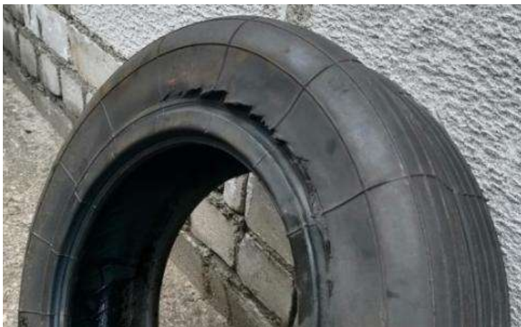
Рисунок 1 – Разрыв резинокордного слоя вместе с капроновым кордом
