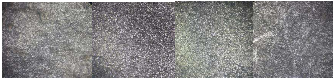
Рисунок 7 – Микроструктура стали 20ГЛ после нормализации и отпуска (×100)
