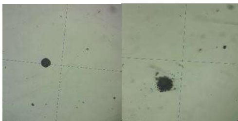
Рисунок 6 – Неметаллические включения в стали 20ГЛ
