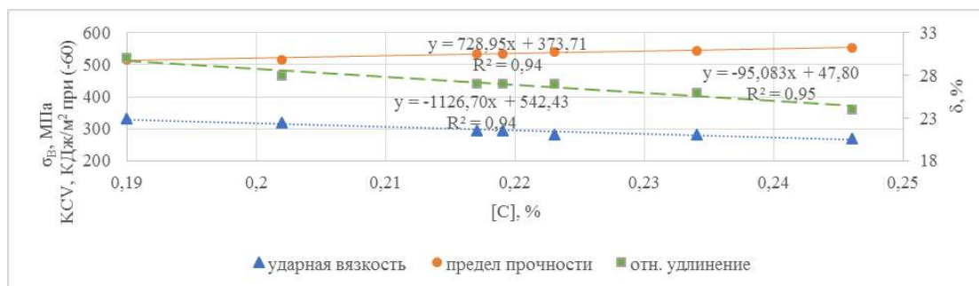
Рисунок 1 – Зависимость механических свойств от содержания углерода
