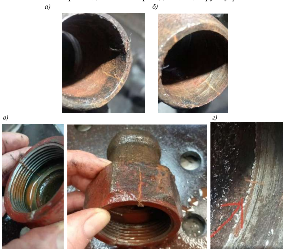
Рисунок 3 – Трещины, выявленные с помощью магнитной установки УМДП-01:
