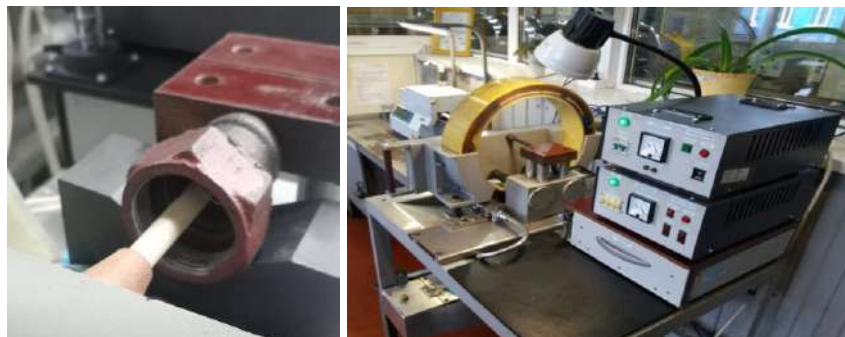
Рисунок 2 – Намагничивание наконечника тормозного рукава вагона с помощью магнитной установки УМДП-01
