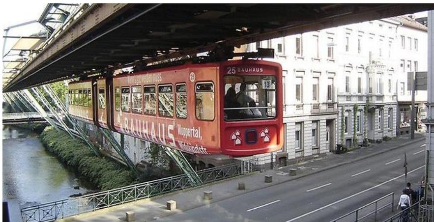
Рисунок 61 – Подвесная монорельсовая дорога в Вуппертале (Германия)
