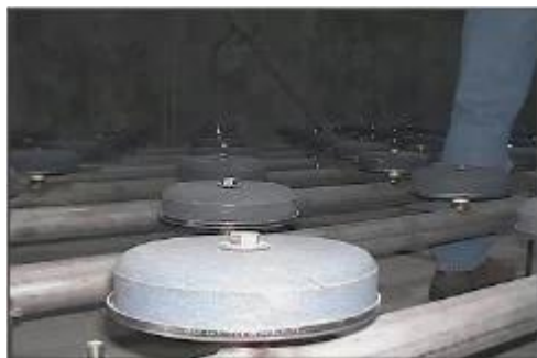
Рисунок 11.38 – Пористые купольные керамические аэраторы (Spartan Environmental Technologies, LLC, США) и схема их работы
