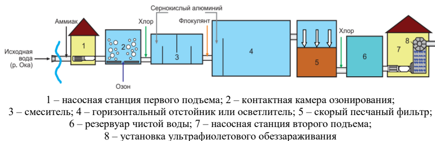
Рисунок 6.8 – Технологическая схема очистки воды на Слудинской водопроводной станции [71]
