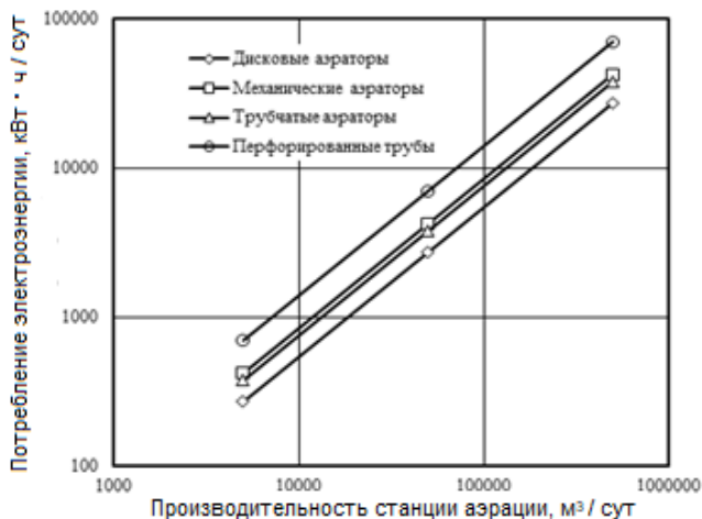
Рисунок 11.13 – Зависимости энергопотребления от производительности станций аэрации, оборудованных аэраторами различных типов
