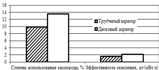
Рисунок 11.12 – Сравнение степени использования кислорода и эффективности окисления различными пористыми аэраторами
