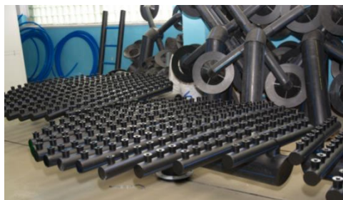
Рисунок 10.4 – Дренажно-распределительные системы из гофрированной ленты коррозионно-стойкой стали
