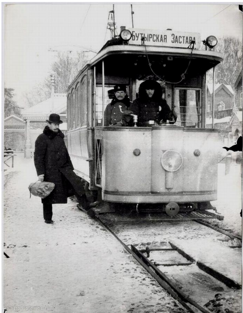
Один из первых электрических трамваев Москвы, изготовленный на Гамбургском заводе "Фалькенрид", и эксплуатировавшийся на первой в Москве линии электрического трамвая
