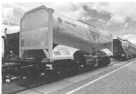
Рисунок 2 – Кузова типа «цистерна» SlurryTaine : а – общий вид; б – крепление на платформе
