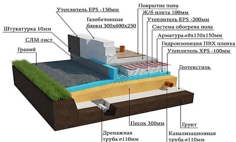
Рисунок 1 – Конструкция фундамента УШП
