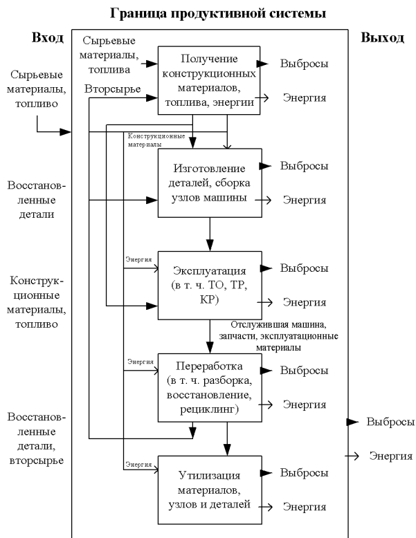
Рисунок 3.6 – Схема жизненного цикла машины с потоками веществ и энергии (под выбросами понимается любое материальное загрязнение окружающей среды)
