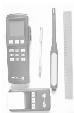
Рисунок 56 – Универсальный измерительный прибор Testo-400 с зондом-крыльчаткой, зондом влажности и температуры и принтером
