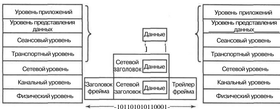
Рис. 1.3. Задачей сетевого уровня является передача данных по сети, посредством инкапсуляции данных и заголовка
