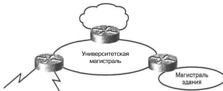
Рис. 9.3. Уровень распределения определяет метрики путей и управляет доступом к службам и сетевыми уведомлениями
