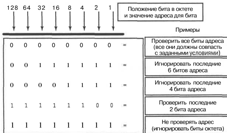
Рис. 6.6. Тщательный подбор шаблона маски позволяет выбрать один или несколько IP-адресов для выполнения тестов на разрешение доступа или отказ в доступе
