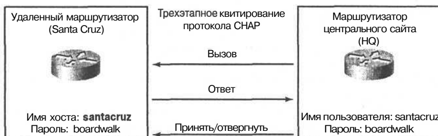
Рис. 10.6. Протокол CHAP используется при создании канала и регулярно после этого для проверки подлинности удаленного узла путем трехэтапного квитирования
