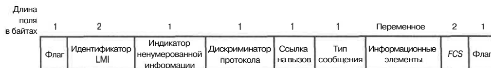
Рис. 12.10. В LMI-фреймах базовый протокольный заголовок такой же, как и у обычного фрейма протокола Frame Relay
