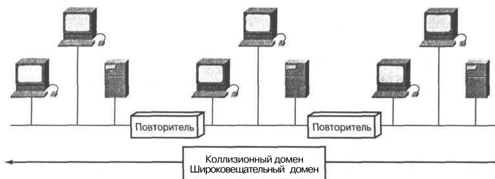
Рис. 2.3. Ethernet-повторитель позволяет вести только одну передачу в каждый конкретный момент; он соединяет все узлы в один коммуникационный канал и передает одни и те же данные на все порты следующего повторителя
