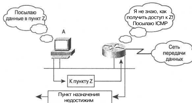
Рис. 1.11. Маршрутизатор отправляет сообщение: "Destination unreachable" ("Пункт назначения недоступен"), указывающее на то что он не может получить доступ к хосту, порту или сети, куда направлен пакет
