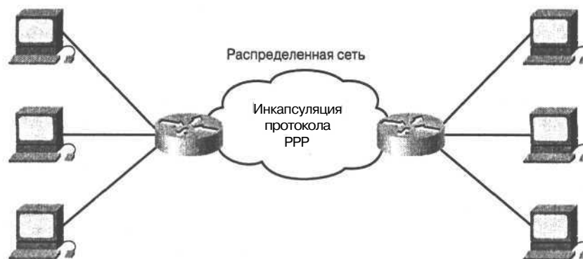
Рис. 10.1. Протокол PPP обеспечивает надежное соединение между маршрутизаторами
