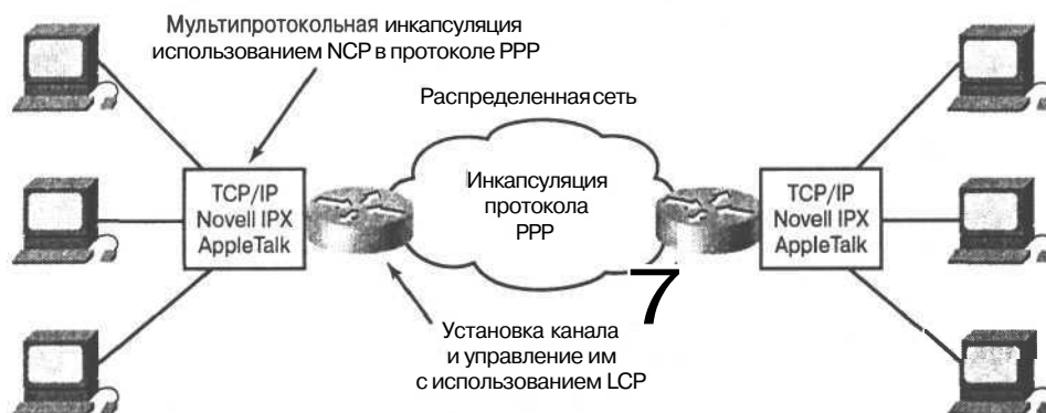
Рис. 10.2. Используя NCP, протокол PPP может передавать пакеты различных протоколов
