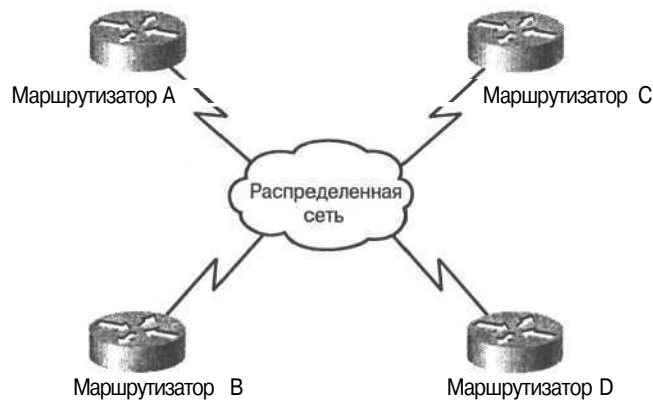
Рис. 8.16. Frame Relay представляет собой пример сетевой технологии с коммутацией пакетов. Она была создана с целью обеспечения большей скорости и простоты в использовании, чем прежние технологии (такие, как X.25), предназначавшиеся для соединения между собой многочисленных сетевых устройств
