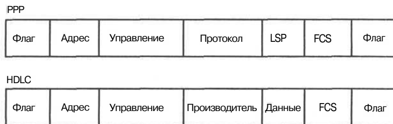
Рис. 8.12. Инкапсуляция типа "точка-точка" обычно используется в выделенных линиях распределенных сетей
