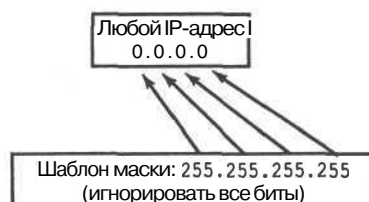
Рис. 6.8. При необходимости задания маски, соответствующей произвольному адресу, вместо длинной строки шаблона маски можно использовать шаблон any
