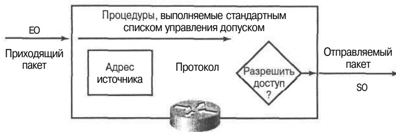
Рис. 6.10. Пакеты, поступающие с интерфейса EO, проверяются на соответствие адресу источника и протоколу
