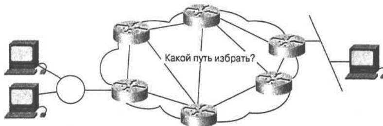
Рис. 1.8. Процедура определения пути позволяет маршрутизатору оценить возможные пути к месту назначения и выбрать наиболее предпочтительный способ обработки пакета
