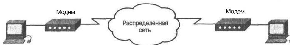
Рис. 8.7. Применение модемов позволяет распределенной сети работать как с аналоговыми, так и с цифровыми сигналами
