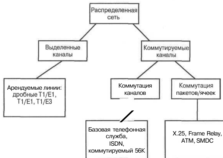
Рис. 8.13. Существуют различные типы соединений, использующих коммутацию пакетов или коммутацию каналов
